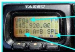
Coloque el VFO A (transmisión) fijo en 145.920 con Tono 67.0 Hz
